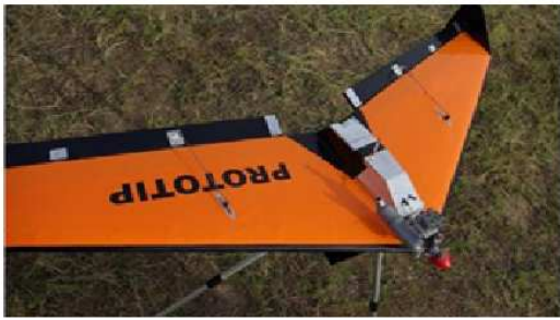
Fig. 5 – Mini UAV with 1.7 m wing span
