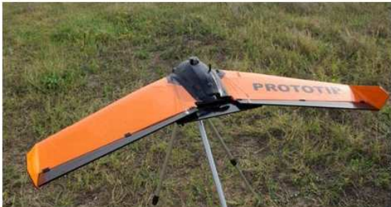
Fig. 4 – Mini UAV with 1.4 m wing span
