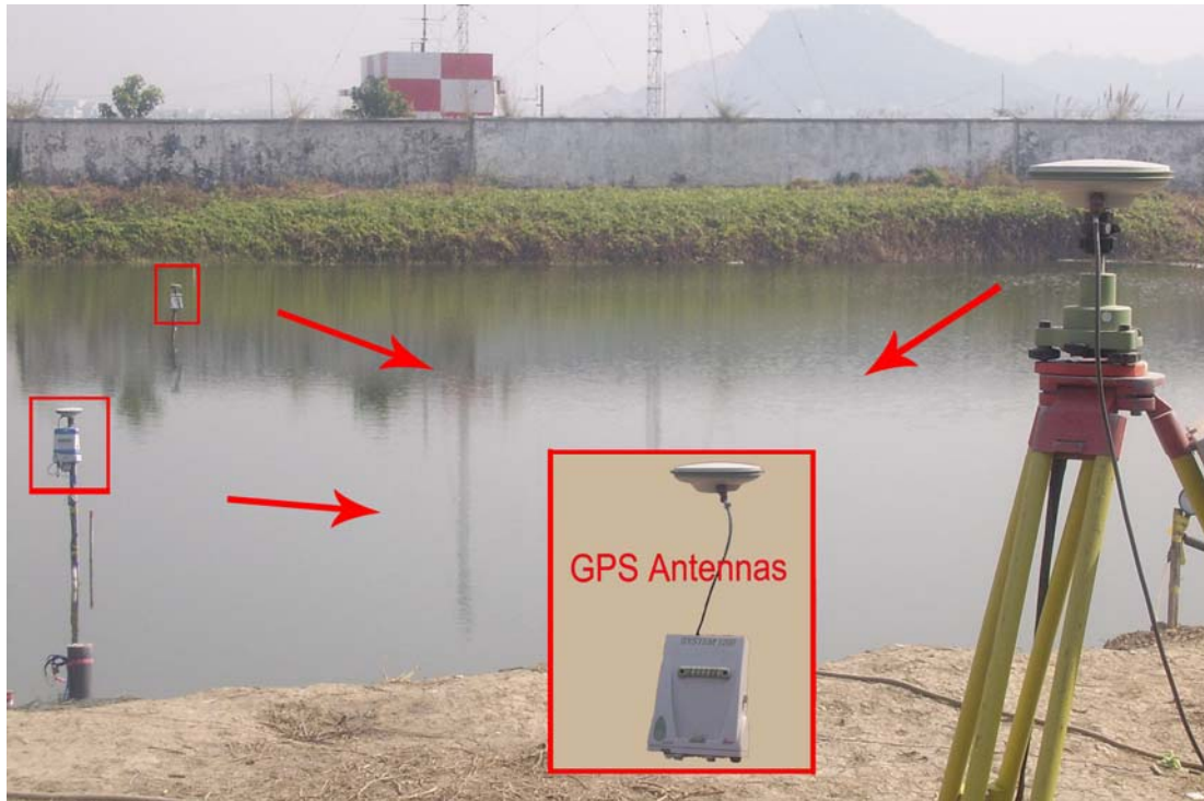
Fig. 6 3 GPS on top of Geomembrane
